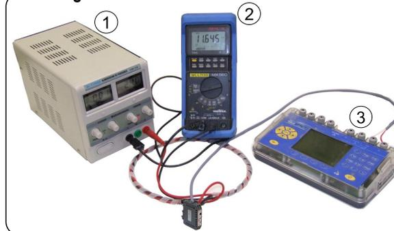
La programmation de la plage de température peut être effectuée en utilisant les résistances de précision de valeur fixe qui simulent la valeur d'un capteur Pt100 (voir tableau des valeurs Pt100 ci-dessous).
